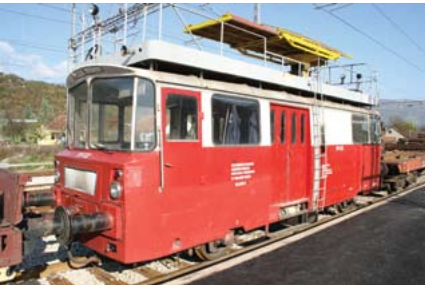
21. Teška motorna dresina za remont i opravku pruge
